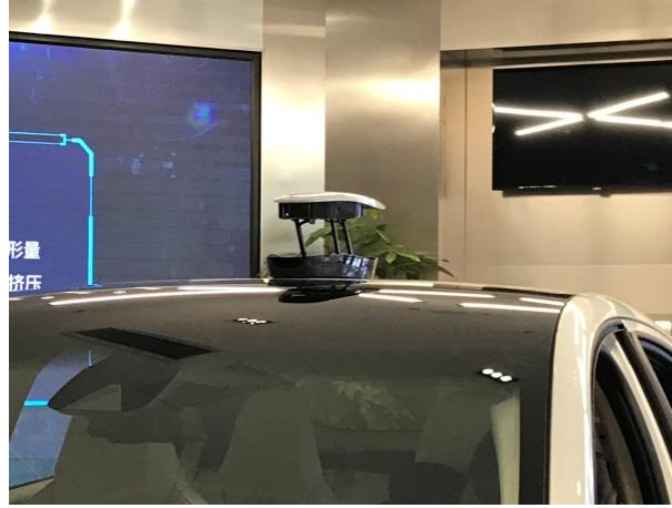
指示後、360度カメラが出て稼働開始
