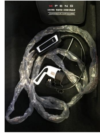
急速充電用コードをトランクに標準装備。充電口は急速(車両の左前)、普通(右前)の2つ
